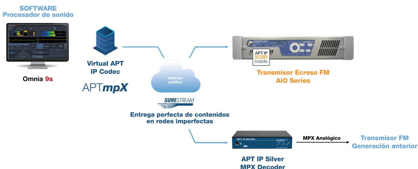
Representación de la infraestructura de nueva generación de la emisora 100% Radio, utilizando Virtual APT IP Codec con APTmpX en el estudio, y dos aplicaciones desplegadas en los sitios de transmisión.
