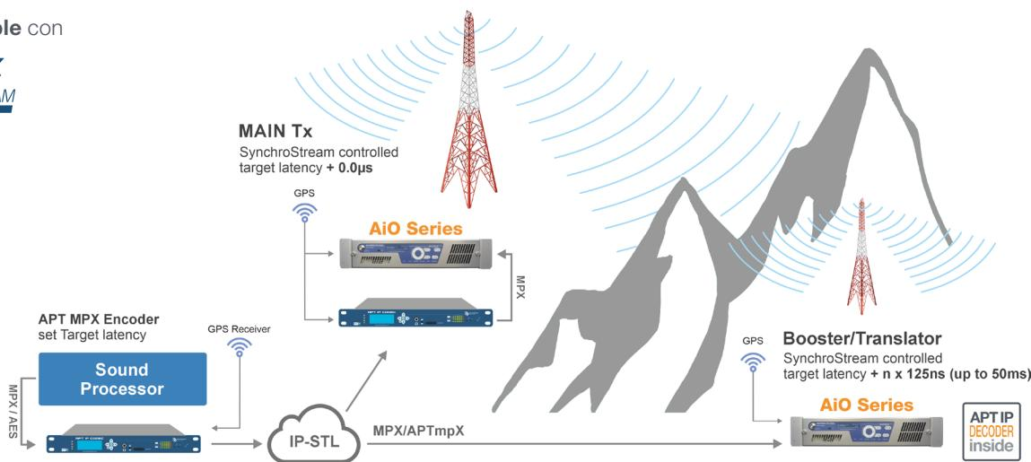
La transmisión en una red de frecuencia única requiere una compensación perfecta de las latencias IP-Link y la gestión de la modulación-temporización
