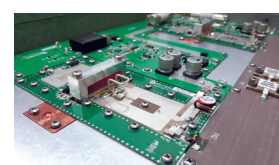
2 paletas RF de diseño planar de 1,25 kW cada una
