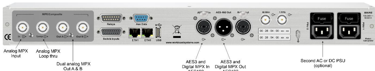
Figure 21: Composants de la face arrière d'un codec MPX
