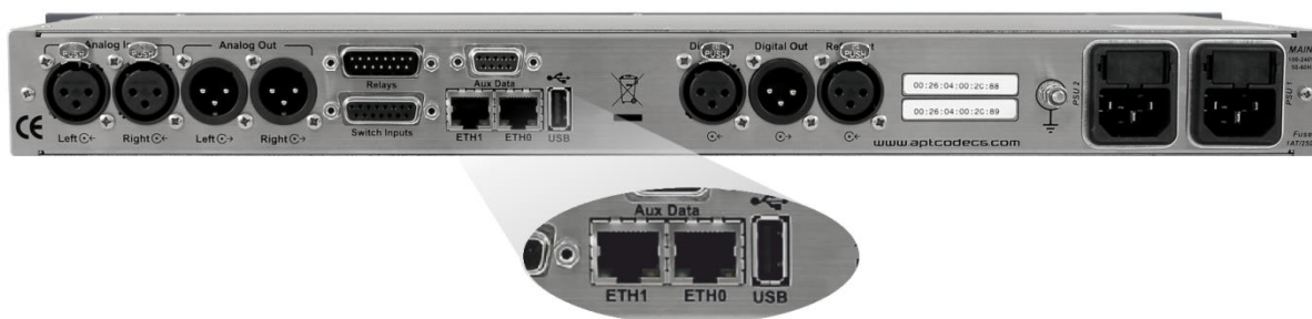
Figura 28: muestra la posición de ETH0 y ETH1 en el panel posterior del APT IP Codec estándar
