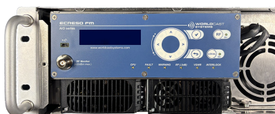
Jusqu'à 2 sources d'alimentation de 3,5 kW échangeables à chaud
